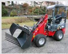
25 PS, 3 Zyl., Fahrerschutzdach, 2 Hubzylinder, 3. Steuerkreis
