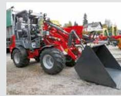
45 PS, 4 Zyl. Fahrerschutzdach, 2 Hubzylinder, 3. Steuerkreis
