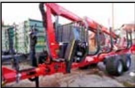
**Stepa Forstanhänger FKL 6295** Bj. 17, 9,5 m RW mit Doppelteleskop, 157 mm Greifer, große Hydraulikpumpe mit Eigenversorgung, 12 t, mit DL-Bremse, **VB 39.590,-**
