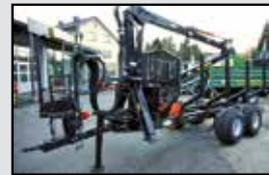
**BMF Forstanhänger Kombi 720** Doppelrahmenanhänger mit hydr. Bremse, Untenanhängung, eigene Ölversorgung, ON-OFF Steuer., RW 7,2 m, großer Greifer, **VB 22.890,-**
